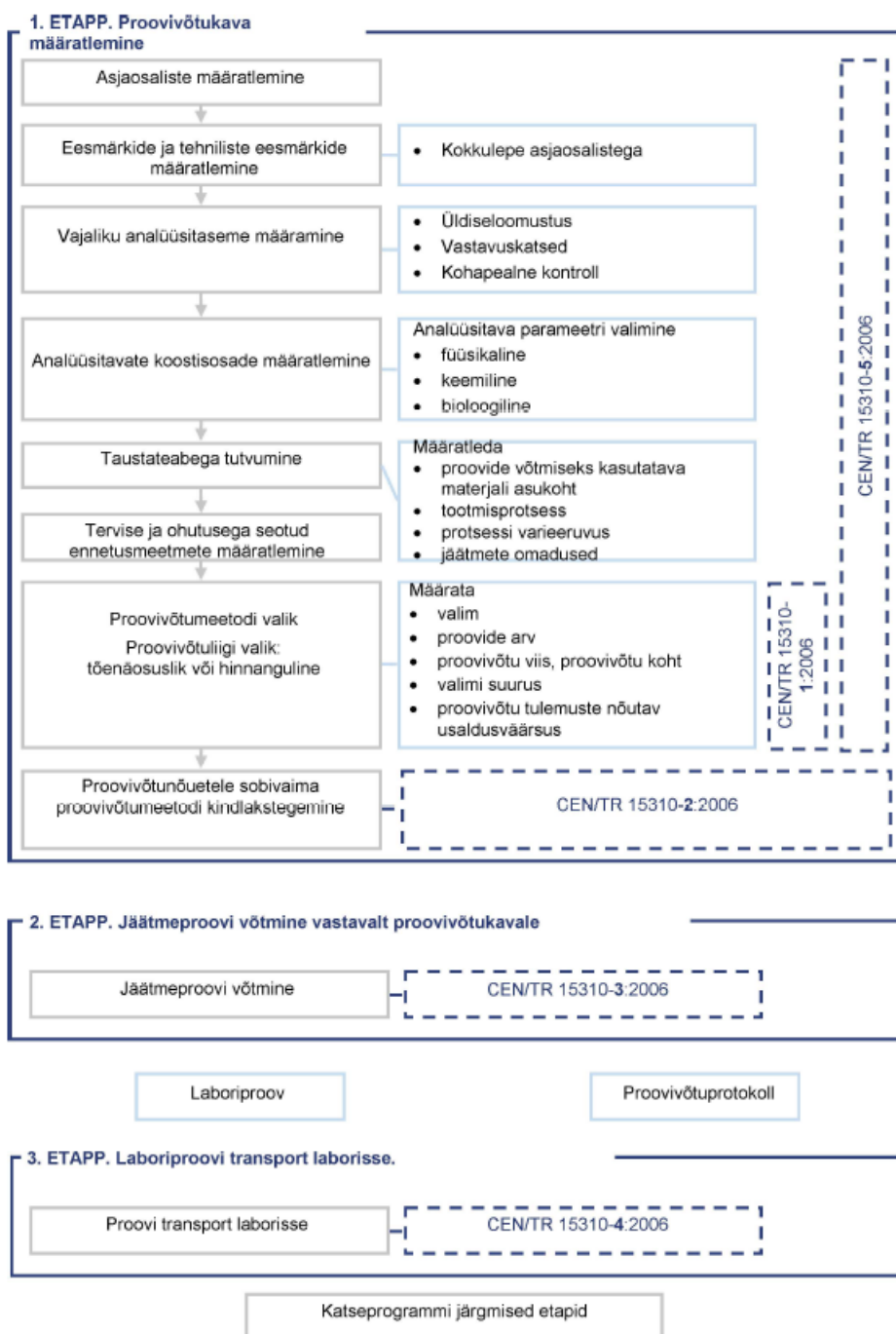
Joonis 2. Proovivõtumetoodika põhielemendid (vastavalt standardile EN 14899:2005) 8
